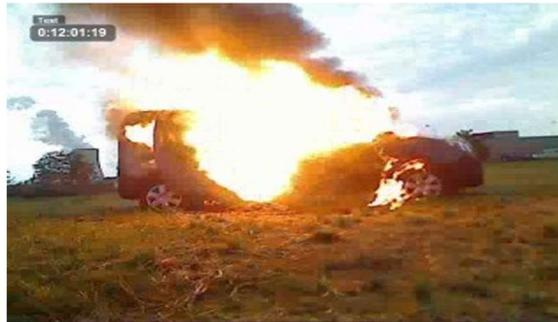
Brulage en infrastructure d'un véhicule électrique avec prolongateur d'autonomie  $H_2$  (LCPP/SDIS 86/SDIS 44/Mouthon Formation), couplé à un véhicule thermique
